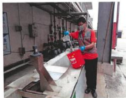
生产废水处理后排出口DW001-样品采集
