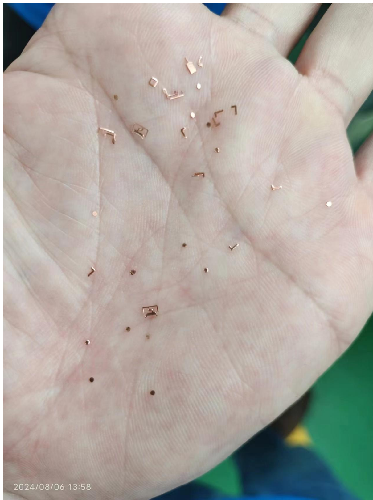
附件 10 冲孔碎屑照片
