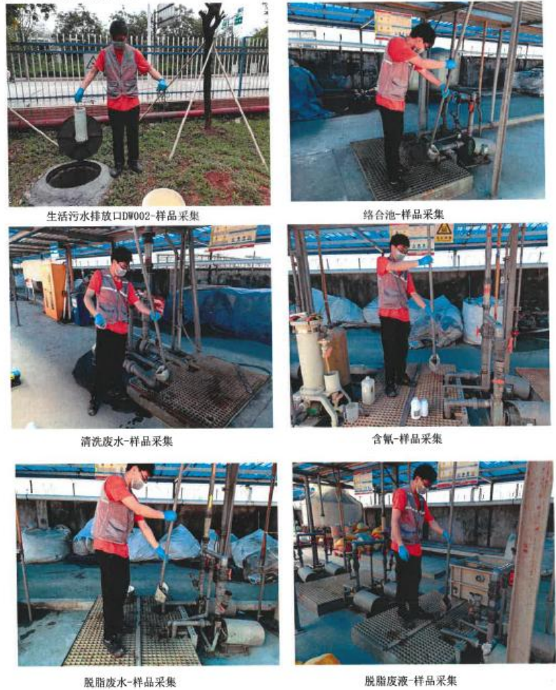
附1: 废水现场部分采样照片
