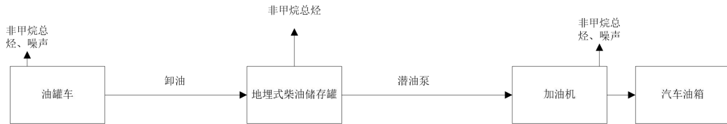
图 3.5-1 项目加柴油工艺流程和产污环节图
